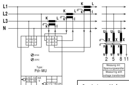
Bei Geräten mit Frequenzmodul entfallen weitere Ausgänge. An den Klemmen +13 und -14 steht der Frequenzausgang zur Verfügung.
