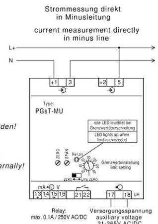
**Achtung!** Bei Übertragung beider Energierichtungen entfällt die Grenzwertüberwachung!
