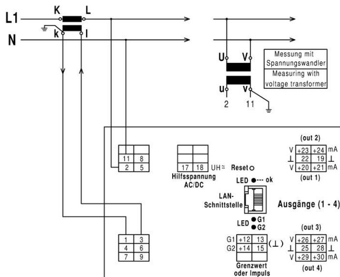
**Achtung!** Bei Messungen im Wechselstromnetz muss die Spannung unbedingt an den Klemmen 2 und 11 und der Strom an den Klemmen 1 und 3 angeschlossen werden.
