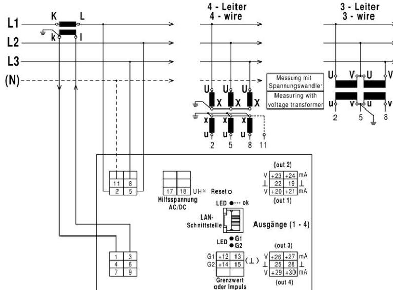
**Wechselstrom** (nicht verwendete Ein- und Ausgänge bleiben unbeschaltet)
