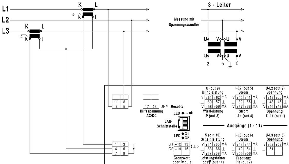
3-/4-Leiter-Drehstrom, gleicher Belastung (nicht verwendete Ein- und Ausgänge bleiben unbeschaltet)
