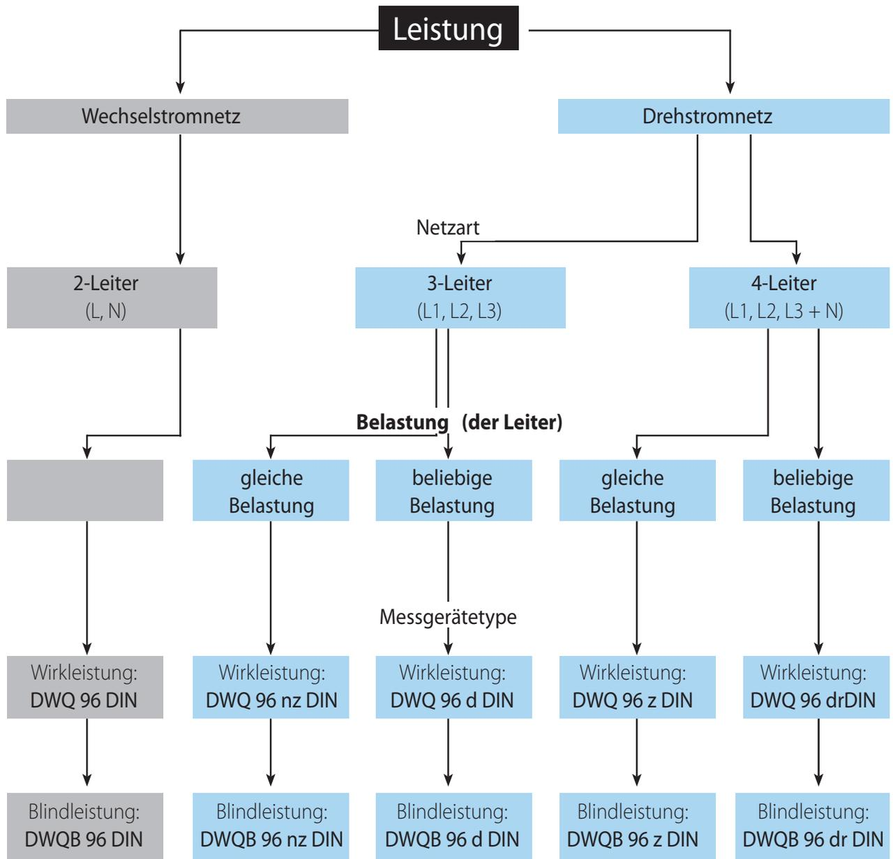
Bei diesen Typen (DWQ 96 ... DIN) ist die Elektronik generell eingebaut (Einbautiefe 57 mm).
