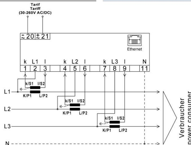
**Achtung!** Die Geräte dürfen nur mit getrennten Stromwandlern betrieben werden! Beim Anschluss der Eingangsgröße Strom ist die Stromrichtung zu beachten!
